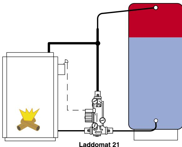
Potrubí ke dnu zásobníku nesmí být vedeno do výšky směrem ke stropu. U takového připojení by došlo ke zrušení samovolné cirkulace.
