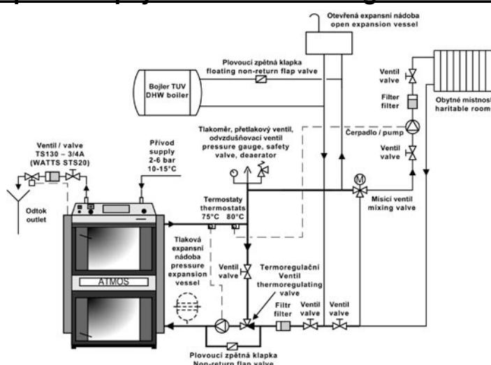
**POZOR** - je-li zapojena chladící smyčka proti přetopení, můžeme plovoucí zpětnou klapkou na obchvatu čerpadla a termoventili vynechat. V případě umístění klapky na vstup vody do chladící smyčky, z důvodu zabránění možného zpětného proudění vody, díky poklesu tlaku ve vodovodním řádu, musíme chladící smyčku vybavit pojistným ventilem 6 - 10 bar nebo uzavřenou expanzní nádobou o min. objemu 4 l.
