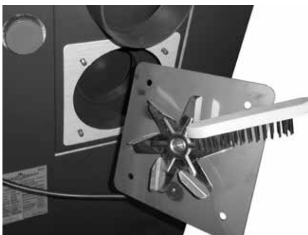
Muster – die Reinigung und die Kontrolle der Schaufel bei Saugzuventilator (außer PX10)
