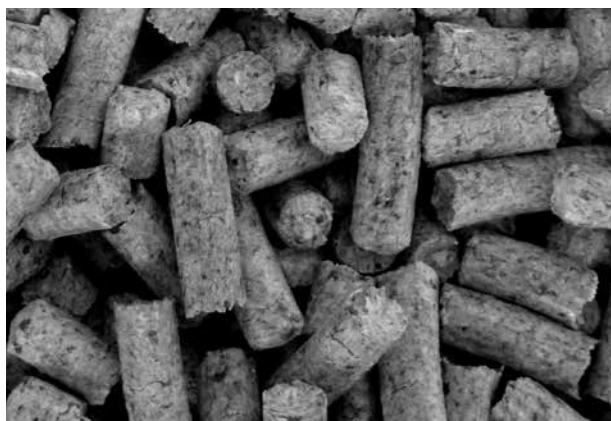
Mangelhafte Holzpellets - dunkle mit Rinde (mit schwarzen Punkten)
