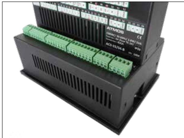
Reliový modul ACD 03/04-B (silová část) a popis připojovacích svorek na zadní straně regulátoru
