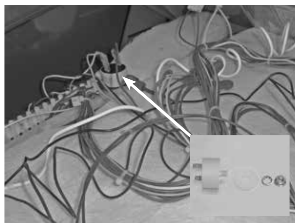
Kondensator für Abzugventilator - 1µF
