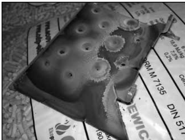
Exemple de l'encrassement léger des orifices de la chambre de combustion après 4 mois d'utilisation
