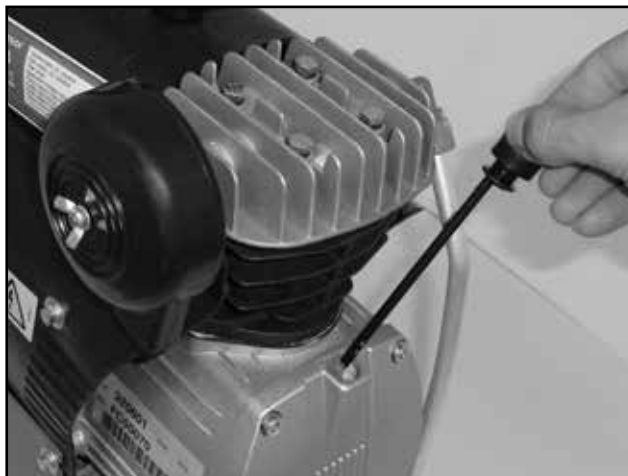
Exemple de contrôle de l'huile dans le compresseur
