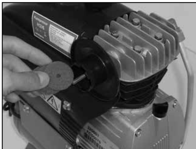
Exemple du nettoyage du filtre du compresseur
