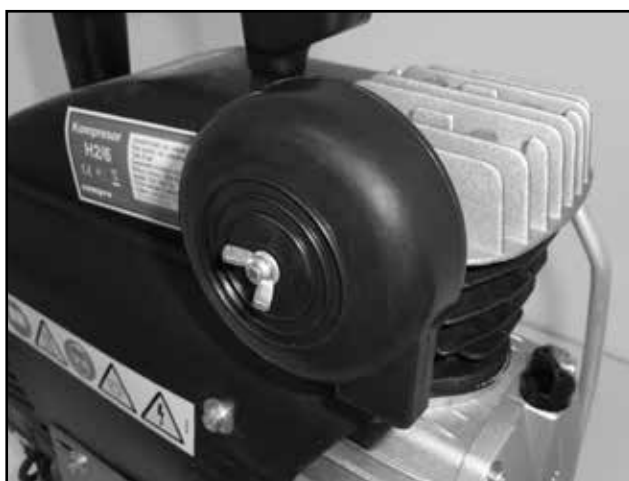
Photo du filtre d'aspiration vissé sur le compresseur
