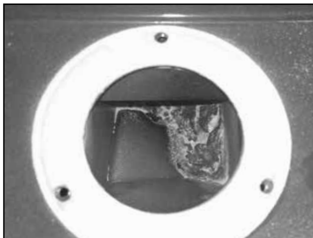
Exemple de l'encrassement après 3 mois de service avec des pellets granulés avec une grande quantité de la poussière
