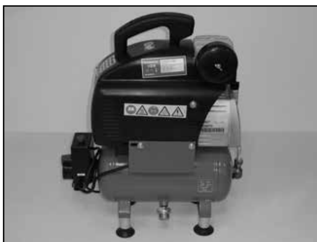
Compresseur modifié pour les buts du nettoyage pneumatique
