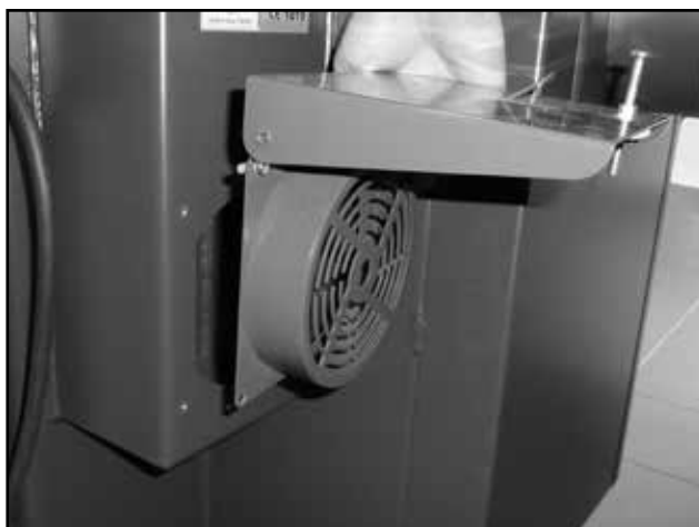
Démontage de la valve pour l'arrivée d'air de combustion
