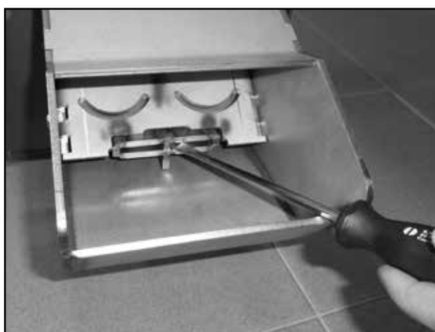
Exemple du nettoyage d'une partie avant du canal pour l'arrivée d'air comprimé
