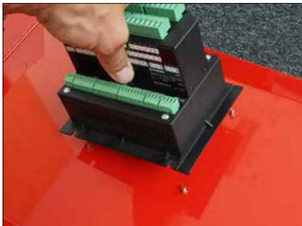
Umieszczenie regulatora na cztery śruby M4
