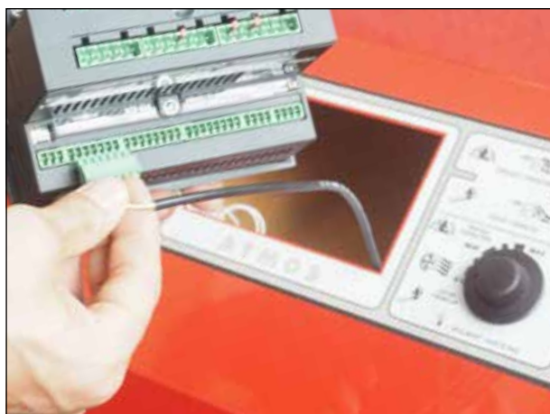
Exemple de connexion de connecteurs individuels
