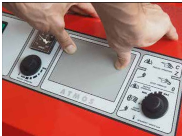
Percer l'ouverture à la main
