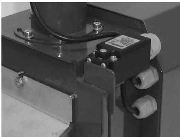
Rys. 8 - wyłącznik końcowy ze specjalnym ogranicznikiem
