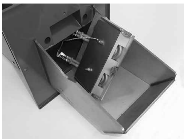
Rys. 4 - Zdemontowana pokrywa z grzałkami rozpalającymi
