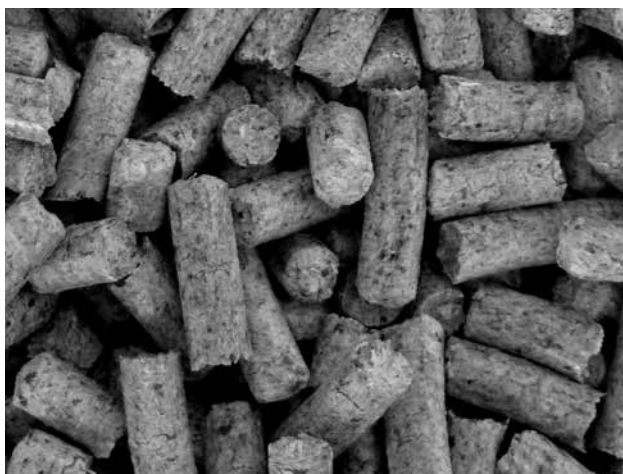
Rys. 18 – Pellet słabej jakości – ciemny z korą (z czarnymi kropkami)
