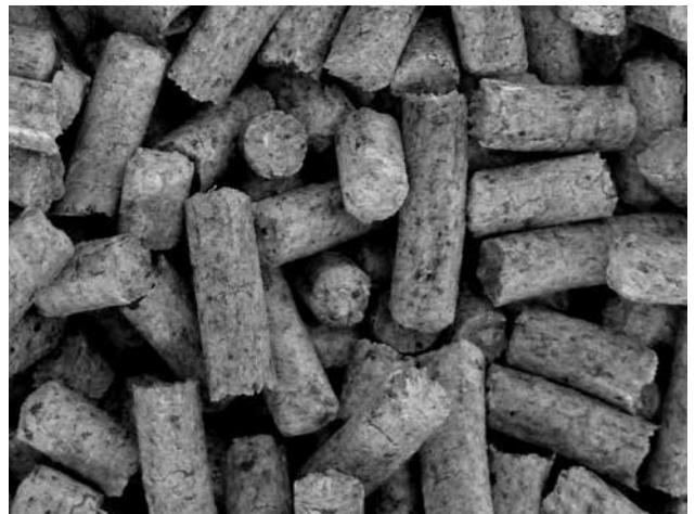
Fig. 18 - pellets en bois d'une mauvaise qualité – foncés, avec l'écorce (points noirs)
