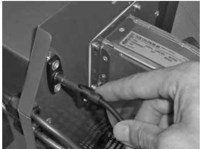
Fig. 6 - photocellule - respectez son orientation correcte - nettoyage annuel recommandé
