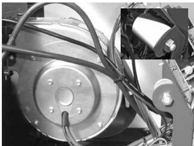
Fig. 9 - compte-tours du ventilateur et condensateur de démarrage
