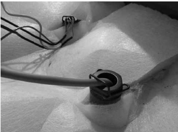
Fig. 15 - vue du capteur de température de l'eau TK dans le bac de la chaudière DCxxP, Pxx
