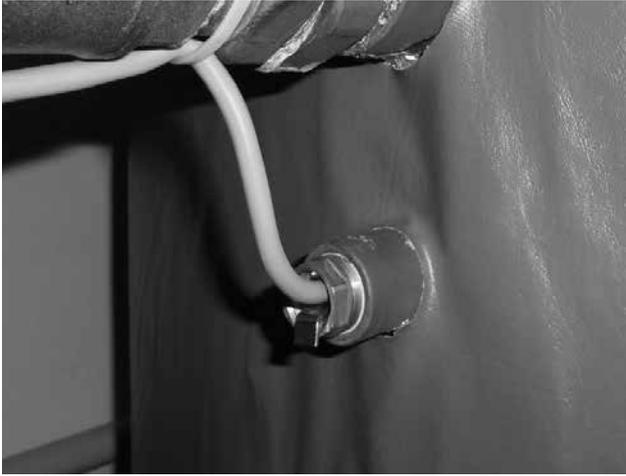
Fig. 13 - vue des capteurs de température situés dans le bac du bassin (TV et TS)
