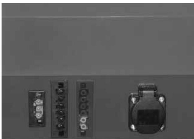
Fig. 12 - brûleur - deux connecteurs à 6 fiches, à gauche le connecteur de puissance à droite le connecteur pour les capteurs, connecteur à 3 pins pour le raccordement du compte-tours du ventilateur de la chaudière et la dose d'alimentation du convoyeur
