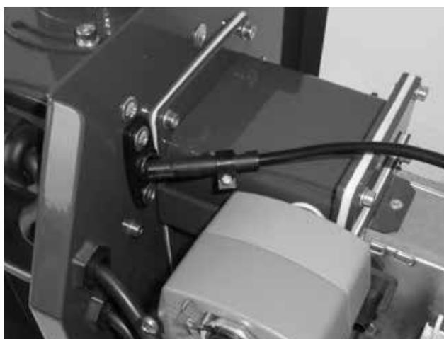
Fig. 6 - photocellule - **respectez son orientation correcte** - nettoyage annuel recommandé
