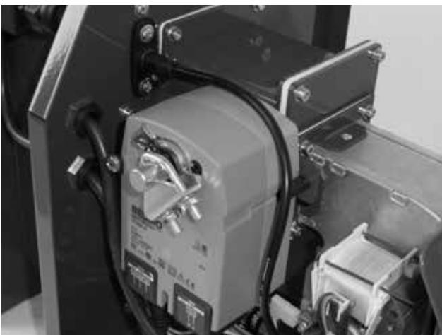
Fig. 11 - volet spécial avec un servomoteur
