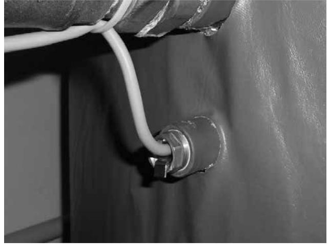
Fig. 14 - vue des capteurs de température situés dans le bac du bassin (TV et TS)
