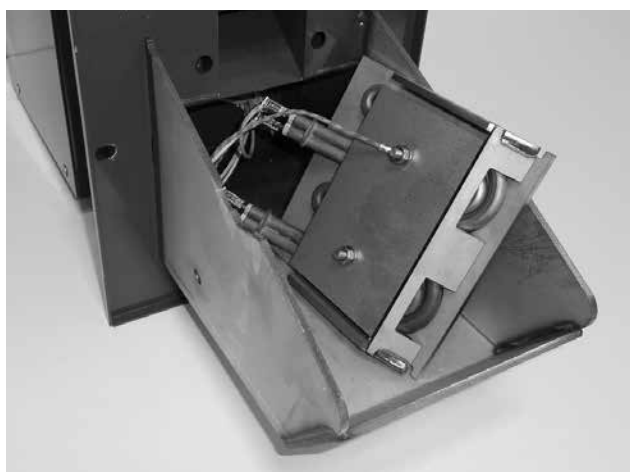
Rys. 3 - zdemontowana pokrywa z grzałkami rozpalającymi
