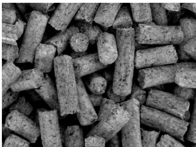
Rys. 18 - pellet słabej jakości - ciemny z korą (z czarnymi kropkami)
