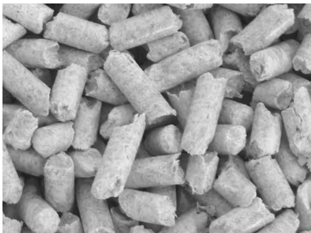
Rys. 17 - pellet wysokiej jakości – biały bez czarnych kropek (kory)
