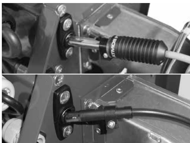
Fig. 4 - photocellule - respectez son orientation correcte - nettoyage annuel recommandé nouvelle photocellule / ancienne photocellule
