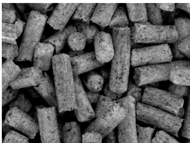
Fig. 18 - pellets en bois d'une mauvais qualité - foncés, avec l'écorce (points noirs)
