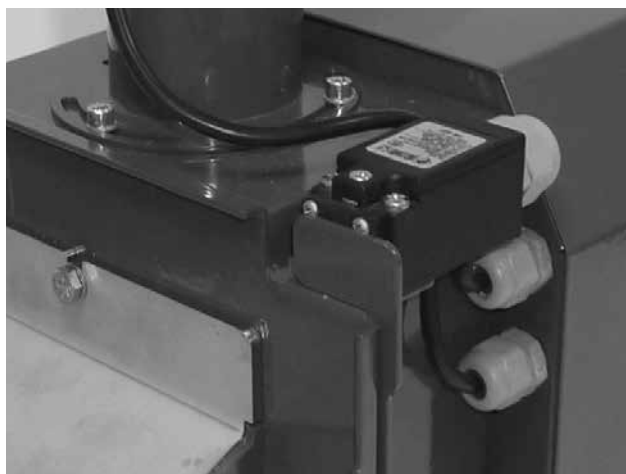
Fig. 8 - interrupteur de fin de course avec sa butée spéciale
