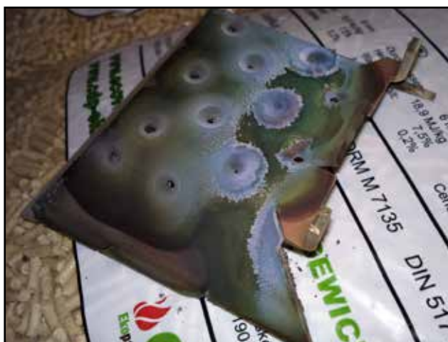
Ukázka lehkého zanesení dírek ve spalovací komoře po 4 měsících provozu
