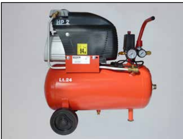
Upravený kompresor pro účely pneumatického čištění
