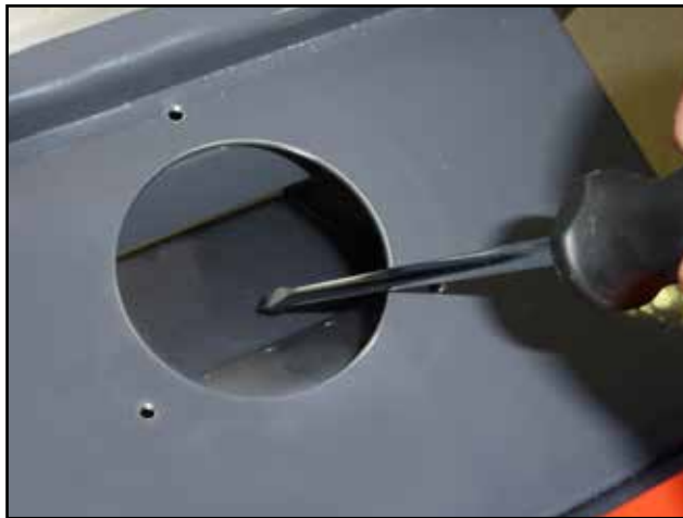
Ukázka čištění prostor pod přívodní trubicí pelet
