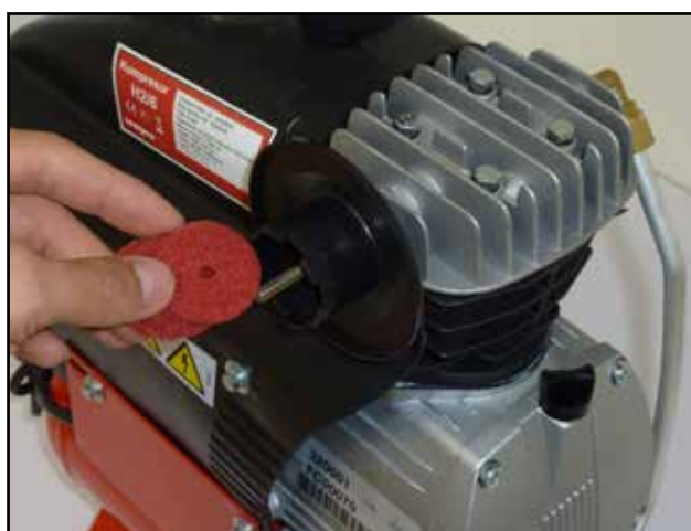
Ukázka čištění filtru kompresoru
