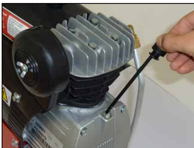
Ukázka kontroly olejové náplně v kompresoru
