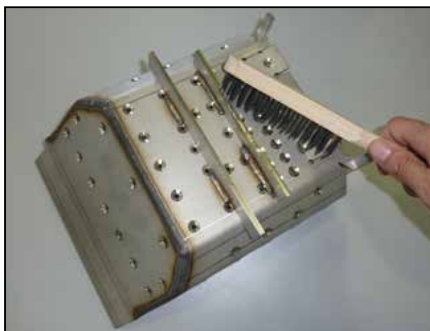
Ukázka čištění spalovací komory
