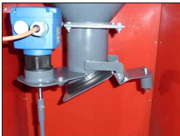
Klapka odlučovacího zásobníku během plnění - podtlakem uzavřena
