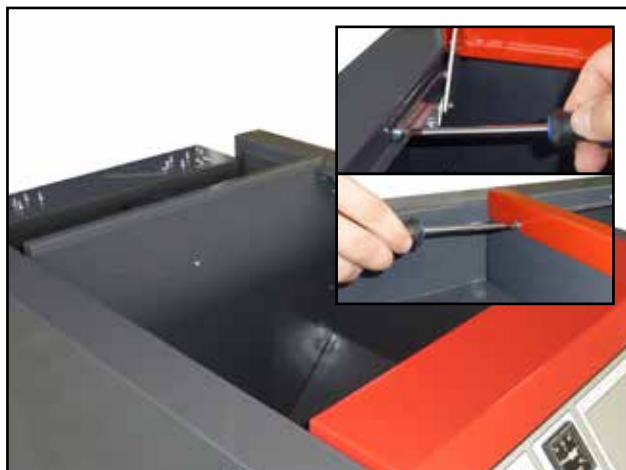
Odšroubování víka s panty a spojovací kapoty - zásobník připravený pro instalaci rámečku
