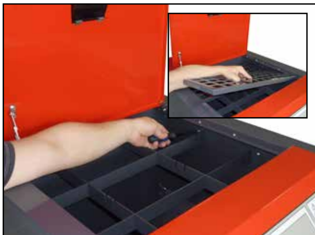
Vyjmutí ochranné mříže a odšroubování držáku mříže ze zásobníku
