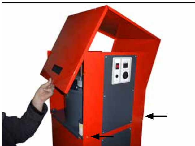
Pro kontrolu motoru nebo odlučovacího zásobníku je možné odšroubovat prostřední kapotu
