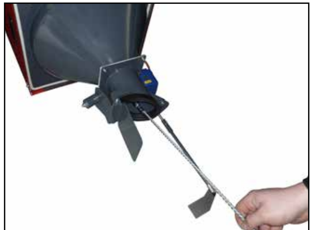
Čištění sítka kartáčem skrz výsypný otvor pelet
