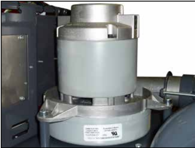
Motor sacího ventilátoru pneumatické dopravy
