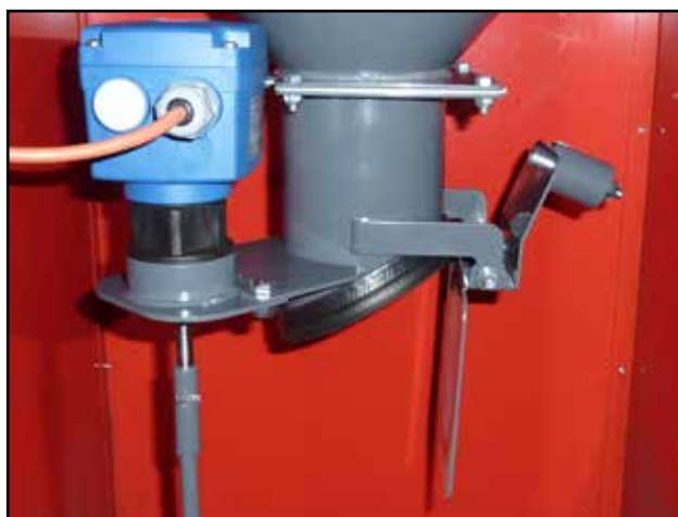
Klapka odlučovacího zásobníku během vyprázdnění - samovolně otevřena vahou vypádávajících pelet
