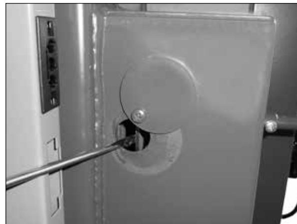
Die Kontrolle und Reinigung der Öffnung bei der Primär-sekundärluft (Einstellhebel)
