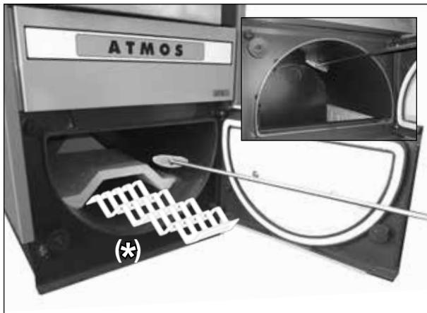
Geöffneter Unterraum des Kessels mit Dach und mit Vorführung der Ascheentleerung mittels Schürhakens. (\* Abgasbremse nur bei DC50S)
