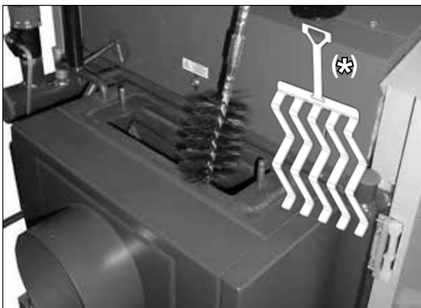
Vorführung der Reinigung des Rauchkanals mit Drahtbürste. Entfernen Sie vor der Reinigung immer die Abgasbremse. \* Abgasbremse nur bei GS32, GS40, DC50S
